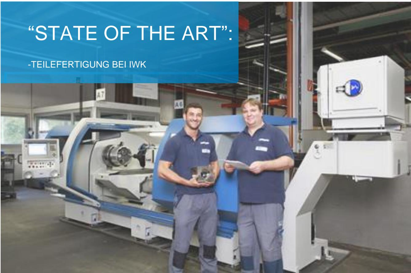
Durch die aktuelle Investition in eine neue CNC Drehmaschine ist IWK auch in der Fertigung von Teilen „State of the Art“. Je nach Zeichnung bearbeitet die neue CNC Maschine ein Teilespektrum welches auch in den Zykloiden der IWK Kartoniermaschinen als Kernkompetenzteil verbaut wird. Drehschiebergehäuse, Zykloiden Deckel, Kurven und Formateile können auf dieser Maschine in höchster Qualität gefertigt werden.
